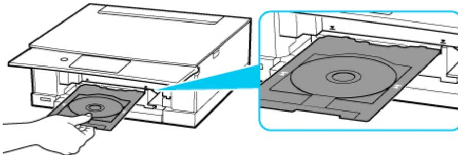
14. Schieben Sie das Multifunktionsfach gerade in horizontaler Richtung ein, bis der Pfeil (▼) auf der Multifunktionsfach-Führung grob am Pfeil (▲) auf dem Multifunktionsfach ausgerichtet ist.
