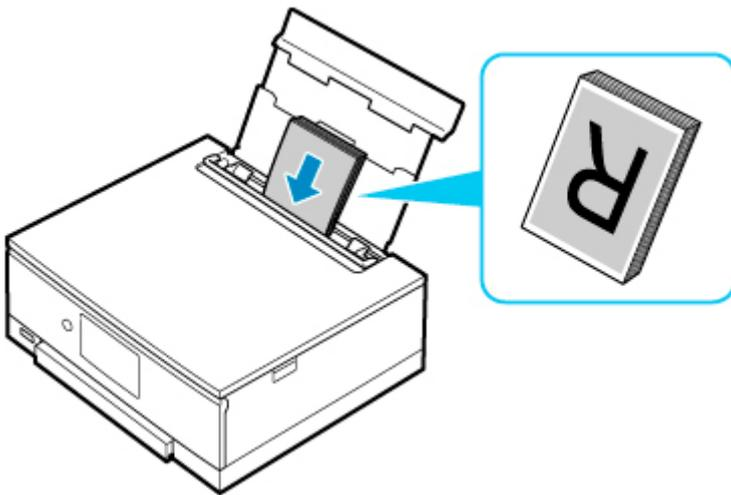
5. Schieben Sie die rechte Papierführung (D), sodass sie an beiden Seiten des Papierstapels ausgerichtet ist.
