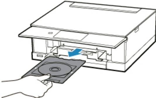
17. Halten Sie die Verriegelung (M) gedrückt, entnehmen Sie den bedruckbaren Datenträger aus dem Schlitz (N) am Multifunktionsfach und entfernen Sie es.
