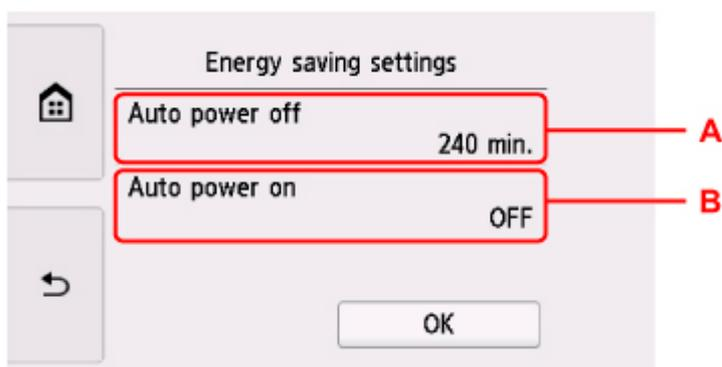
A: Legen Sie den Zeitraum fest, nach dem der Drucker automatisch ausgeschaltet wird, wenn keine Aktion ausgeführt oder keine Druckdaten an den Drucker gesendet werden.
