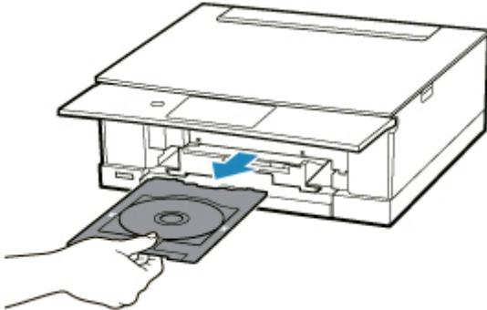
18. Halten Sie die Verriegelung (K) gedrückt, entnehmen Sie den bedruckbaren Datenträger aus dem Schlitz (L) am Multifunktionsfach und entfernen Sie es.
