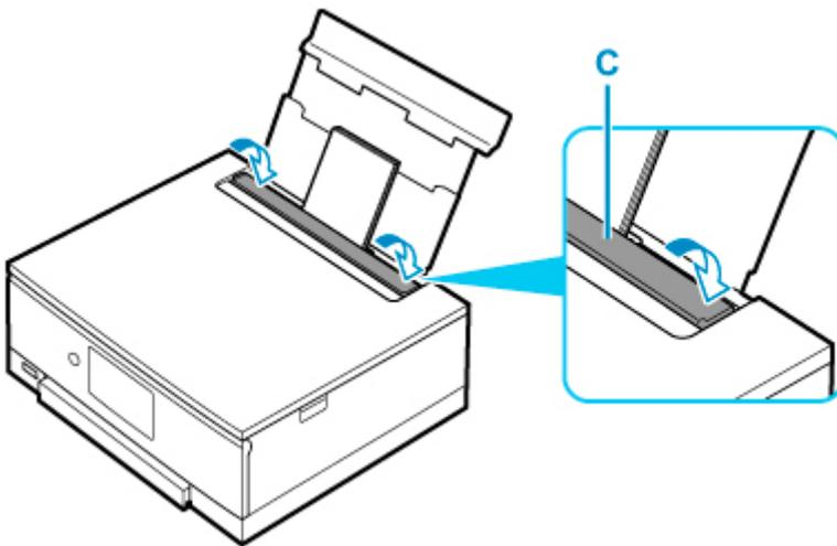
Nachdem Sie die Abdeckung des Einzugschachts geschlossen haben, wird der Bildschirm zur Bestätigung der Papiereinstellungen für das hintere Fach auf dem Touchscreen angezeigt.
