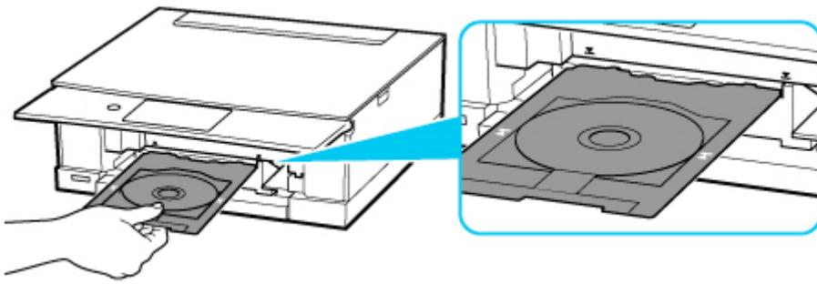
4. Schieben Sie das Multifunktionsfach gerade in horizontaler Richtung ein, bis der Pfeil (▼) auf der Multifunktionsfach-Führung grob am Pfeil (▲) auf dem Multifunktionsfach ausgerichtet ist.
